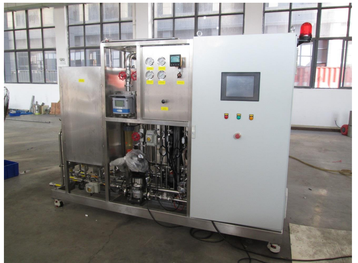
压铸脱模剂废水处理装置
