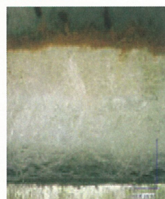
使用“NANOFRONT®”的滤布 粉尘会被阻挡在表层， 所以反吹清扫彻底，此结构不容易造成堵塞。
