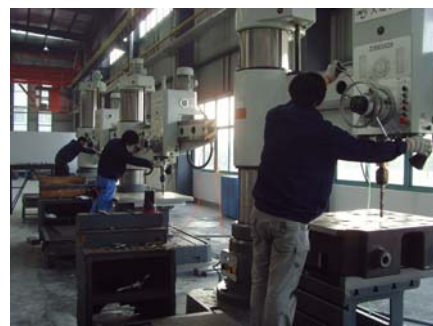
大型钻床加工
